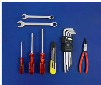
Для взлома методом манипуляции с инструментом DIN EN 1630
