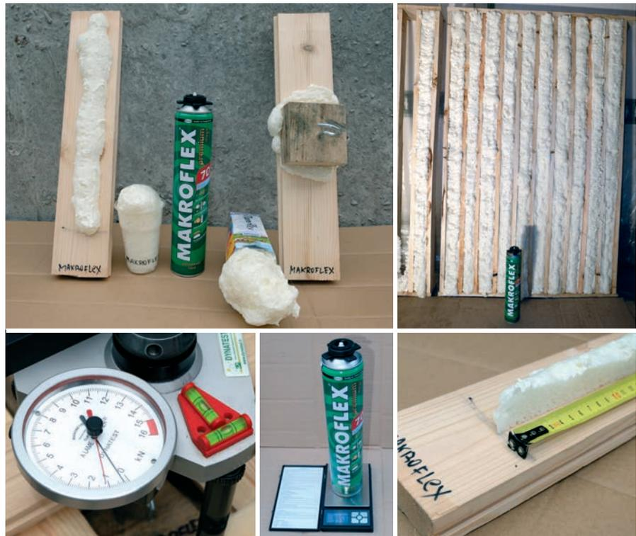
максимальный для этих исследований: 880 миллилитров. Вес полного баллона 1003 грамма. После выпуска пены вес баллона составил 152,9 грамма, соответственно, выход продукта, вследствие выпуска пены из баллона, равен 850,1 грамма. В ходе испытаний, пеной из одного баллона удалось заполнить 14,6 погонных метра шва. Стоимость одного условного метра шва получилась 6.10 грн. Это самый лучший показатель стоимости погонного метра шва в этих сравнительных исследова-
