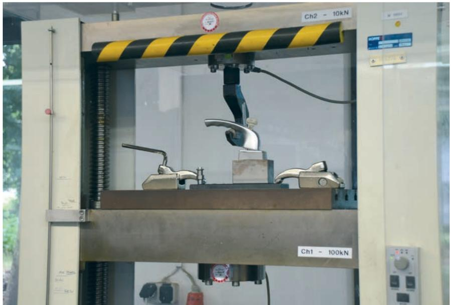
В испытательной лаборатории ХОППЕ прочность оконной ручки в закрытом положении проверяется под экстремальной нагрузкой при помощи крюка
