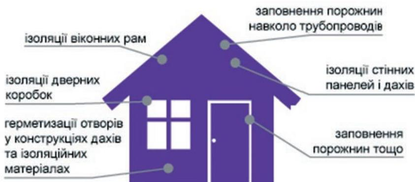
«Ceresit WHITETEQ тепло- і звукоізоляція» використовується для ізоляції віконних і дверних рам, стінових панелей, черепиці тощо.
