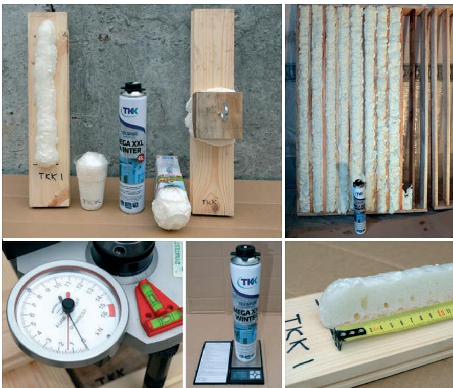
составил 10 мм. Устойчивость пены к усадке на высоком уровне. Образец не выпал из конусного стаканчика. Для проверки на гигроскопичность был изготовлен образец объёмом 1105,5 миллилитра и весом 14,8 грамма. Плотность образца составляла 13,39 грамма на литр. В процессе двухчасовой опрессовки образец пены впитал 21,3 грамма воды и стал весить 36,1 грамма. Гигроскопичность пены была определена на уровне 2,05% объёма. Во время проверки адгезии пены к деревянной поверхности пришлось приложить уси-
