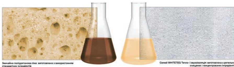
Звичайні поліуретанові піни виготовляються на основі компонентів, які надають їм типового жовтуватого кольору.
