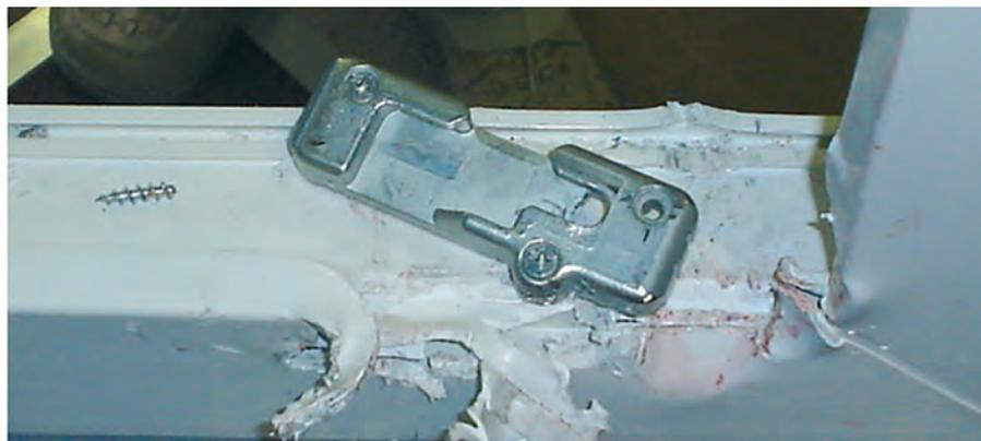
▲ Створка, после успешной попытки проникнуть в окно с противовзломной фурнитурой
