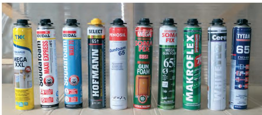
баллонов на электронных весах с точностью до 0,1 г до и после выпуска пены. Разницей веса полного и пустого баллона является выход продукта в граммах.
