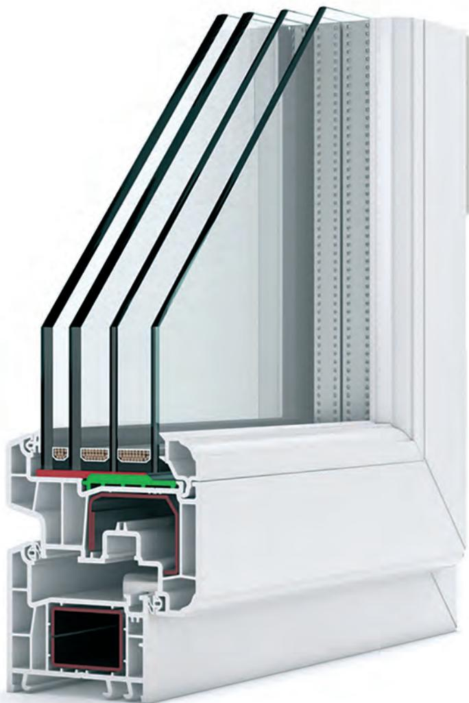
Наряду с широко распространенными однокамерными и двухкамерными стеклопакетами существует еще одна конструкция стеклопакета – трехкамерная.
